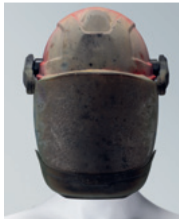
7 kA mértékű átvilés/ívkisülés után
