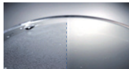
Páramentes (anti-fog) bevonat 8 másodperc után. | uvex supravision ETC bevonat 8 másodperc után.
